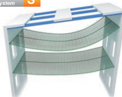
Red de seguridad horizontal con cuerda perimetral. Horizontal safety net with border rope.
