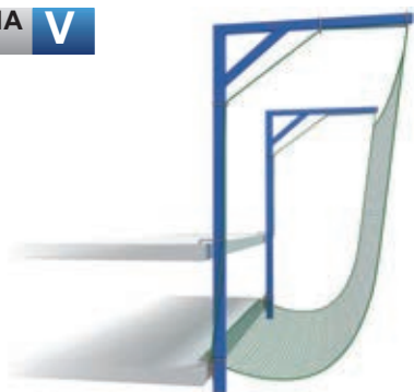
Red de seguridad con cuerda perimetral, para utilizar con horcas o pescantes. Safety net with border rope, attached to a gallow type support.
